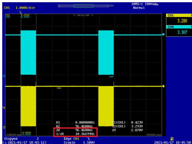
Abbildung 21: Aufzeichnung von SDA(blau) und SCL(gelb) während eines kompletten Aktualisierungszyklus
