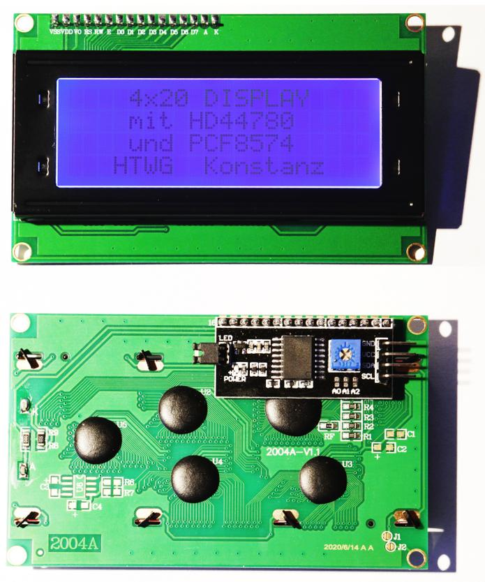
Abbildung 3: 4x20 HD44780 Display mit PCF8574 Adapter Platine
