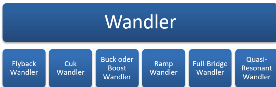
Abbildung 10: Wandler des aktiven Balancing
