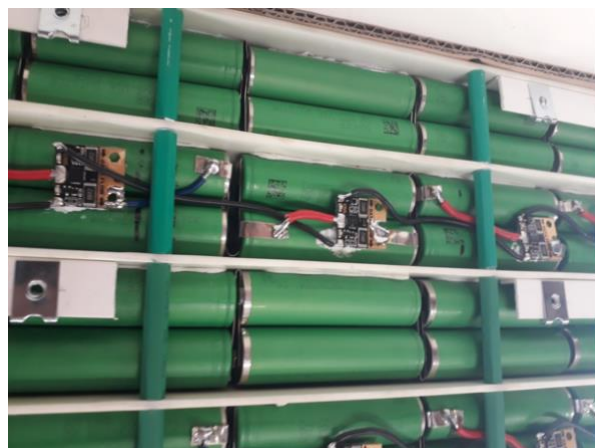
Abbildung 13: Batterie mit Slave Modulen
