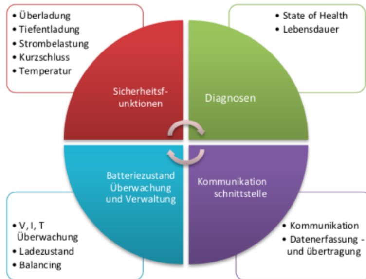
Abbildung 2: Funktionen des Batteriemanagementsystems
