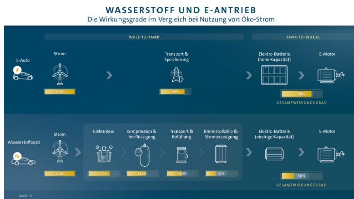
Abb. 5: Vergleich Wirkungsgrad Wasserstoff- und E-Antrieb
