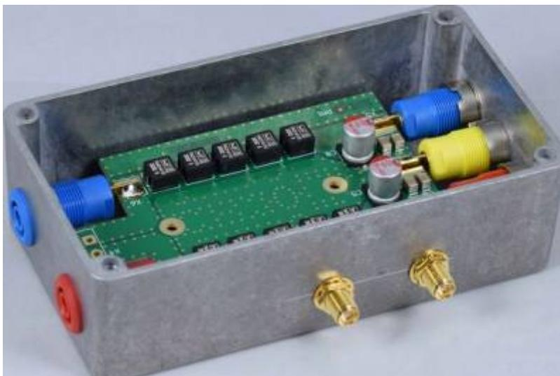
(Bild: [Elektor Magazin](#)) Diese Art der Netznachbildung kann für Messungen nach der CISPR25 bzw. DIN EN55025 verwendet werden. Sie besitzt bereits ein integriertes 10dB Dämpfungsglied welches bei der Messung entsprechend addiert werden muss. Im Labor haben wir noch eine zweite Variante (Entstanden in einer Abschlussarbeit) ohne integriertes Dämpfungsglied.
