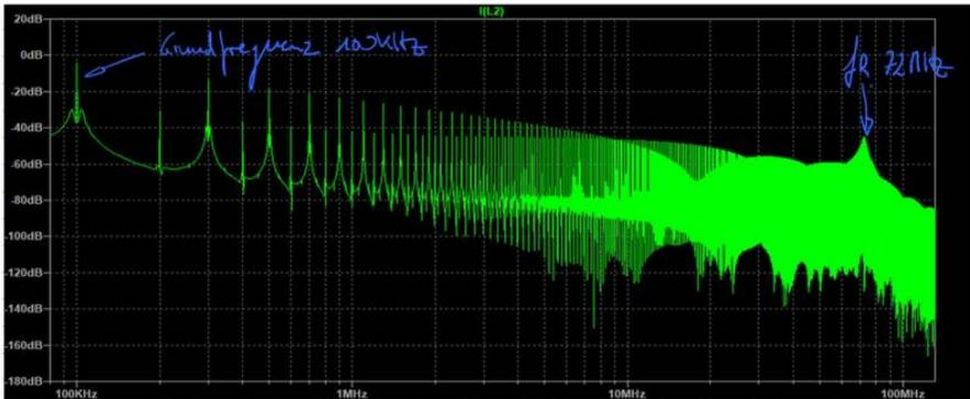
Aus der Resonanzfrequenz und der in unserem Beispiel bekannten Induktivität des Schwingkreises lässt sich der Kapazitätswert berechnen aus:
