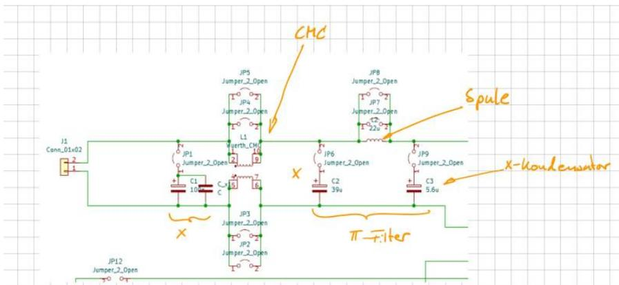
Die Gleichtaktspule und die Filterinduktivität sind fest vorgegeben. Die Bauteile der Kondensatoren können Sie nach belieben wählen. Es muss lediglich der Footprint auf der Platine mit Ihrer Auswahl übereinstimmen. Die im Schaltplan angegebenen Werte sind Richtwerte und müssen nicht übernommen werden. In einem realen Projekt wäre die Schaltung vorgegeben und Sie als EMV- Ingenieur müssen nun mit dem vorhandenen Filerdesign das Beste Ergebnis erzielen.
