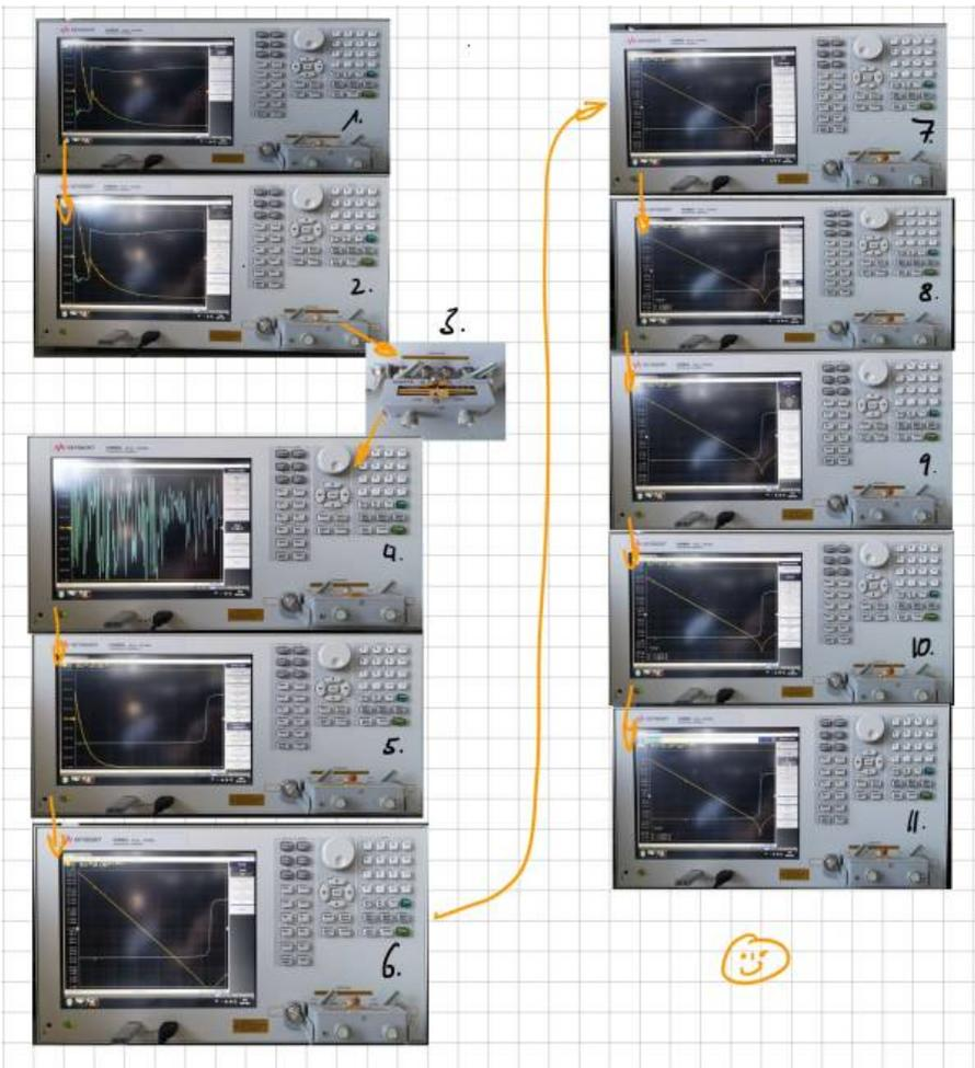
1. Nach dem Hochfahren zeigt der Impedanzanalysator die Impedanz und die Phasenverschiebung in einem bestimmten Frequenzbereich an. Nun muss die verwendete Messeinrichtung kalibriert werden. Dazu wird zuerst mit der Taste „Cal“ das Kalibrierungsmenü geöffnet. Daraufhin muss mit dem Menüpunkt „Accessory“ die verwendete Messeinrichtung ausgewählt werden.
