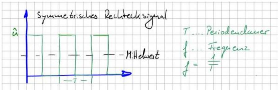
Da die Kurve bei 0V startet und die Nulllinie niemals unterschreitet ist sie auf den ersten Blick nicht mittelwertfrei. Mit bloßem Auge ist zu erkennen, dass der eingezeichnete Mittelwert (schwarze Linie im Bild) irgendwo oberhalb der Nulllinie liegt. Der Mittelwert unserer Funktion wird auch Gleichspannungsanteil genannt und lässt sich mit Hilfe der bekannten Gleichung zur Ermittlung des Mittelwerts berechnen (Kurve integrieren und durch die Integrationszeit teilen).
