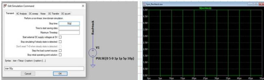
Das Programm erkennt, dass noch keine Simulationsart ausgewählt wurde und zwingt uns nun die Simulationsparameter anzugeben. Standardmäßig wird die Transientanalyse vorgeschlagen bei der wir lediglich die gewünschte Simulationsdauer angeben müssen. Nach erfolgreicher Simulation wird der Mauszeiger zu einer Messspitze, mit der sich Spannungen mit Bezug zur Referenzmasse anzeigen lassen.
