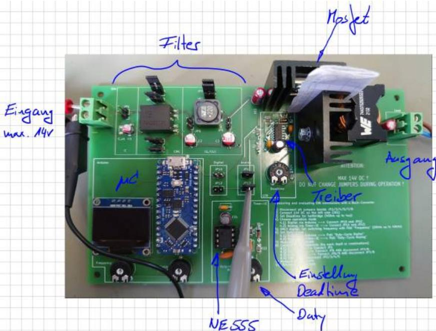
Die Platine enthält einige Jumper zur Aktivierung/Deaktivierung einzelner Filterelemente, sowie der Auswahl der Steuerung über den Timer-IC oder über
