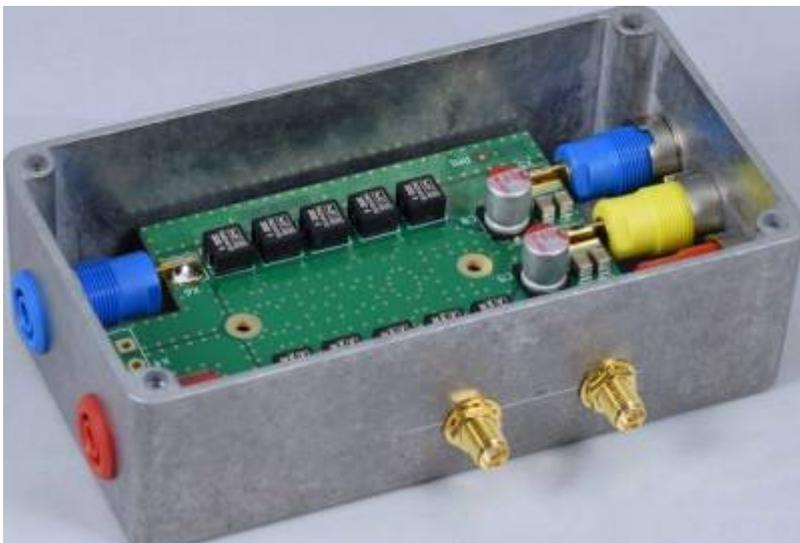
(Bild: [Elektor Magazin](#)) Diese Art der Netznachbildung kann für Messungen nach der CISPR25 bzw. DIN EN55025 verwendet werden. Sie besitzt bereits ein integriertes 10dB Dämpfungsglied welches bei der Messung entsprechend addiert werden muss. Im Labor haben wir noch eine zweite Variante (Entstanden
