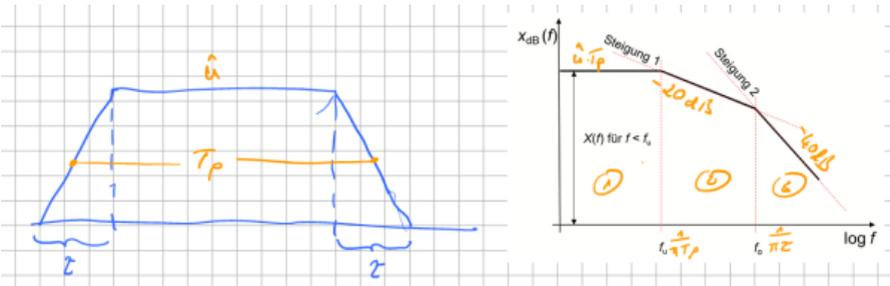
Das Ergebnis des Fourier-Integral zum idealen Rechteckimpuls ist in obiger Abbildung dargestellt. Da wir stets die maximale Störemission suchen, ist es ausreichend das Ergebnis so zu vereinfachen, dass nur noch die Hüllkurve der Spektraldichte betrachtet wird. Dieser Verlauf der Hüllkurve lässt sich in drei Bereiche einteilen.
