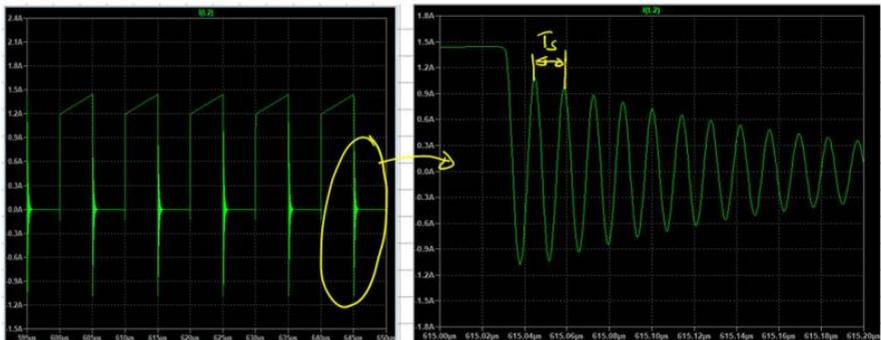
Mit Hilfe der Cursor-Funktion in LT-Spice ermitteln wir die Schwingungsdauer  $T_s$  zu  $14\text{ns}$  woraus sich eine Frequenz  $f_R$  von  $72\text{MHz}$  ergibt. Die Resonanzfrequenz tritt natürlich im Frequenzspektrum deutlich hervor, welches sich durch die Berechnung der FFT-Funktion anzeigen lässt,
