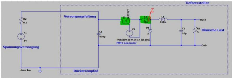
Um die Schwingung zu bewerten messen wir den Strom  $I_s$  durch die parasitäre Induktivität, welcher gleichzeitig auch dem Strom durch unseren Leistungsschalter (Drain-Strom des Mosfets) entspricht. In nachfolgender Abbildung ist die sich ausbildende Schwingung beim Abschalten des Mosfets deutlich zu erkennen.
