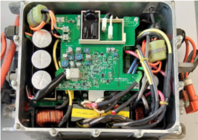
Ladegerät für die Hochvoltbatterie eines Elektro- / Hybridfahrzeugs mit zahlreichen Ferritkernen und EMV-Maßnahmen
