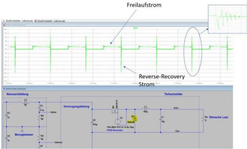
Schön zu sehen ist zum einen der eigentliche Reverse-Recovery Impuls und im Zoom wie durch diesen Impuls die Schaltung zu einer hochfrequenten Schwingung angeregt wird. Ganz verhindern lässt sich dieser Effekt leider nicht. Allerdings können wir ihn minimieren indem schnelle Dioden eingesetzt werden mit einer möglichst geringen Sperrverzugsladung, im Datenblatt unter  $Q_{rr}$  zu finden.
