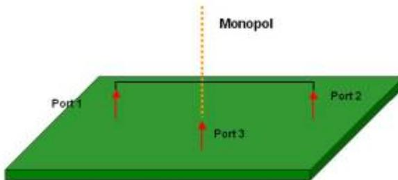
Zur Bewertung der Abstrahlung wird im Folgenden ein Hilfsmonopol in die Simulation mit eingefügt. Der Fußpunkt des Monopol wird dabei als zusätzlicher Port in die Gesamtmatrix der Leiterparameter
