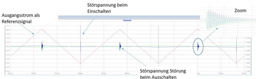
Schauen wir uns die an der Netznachbildung messbaren Störspannungen an können wir feststellen, dass für den Ein- und Ausschaltvorgang unterschiedliche Störgrößen existieren. Wird der Laststrom (rot) mit angezeigt lässt sich einfach
