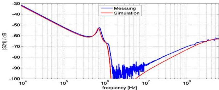
Die Simulation passt erstaunlich gut zur Messung. Man könnte fast annehmen es wurde noch mehr frisiert: Ja, das stimmt. Diesmal allerdings nicht die Bauteilwerte, sondern die Messmethode. Auch durch die Messung können sich Fehler einschleichen. Ironischerweise handelt es dabei um ein EMV-Problem ..... Die Messmethode möchte ich anhand der nächsten Filterschaltung vorstellen.
