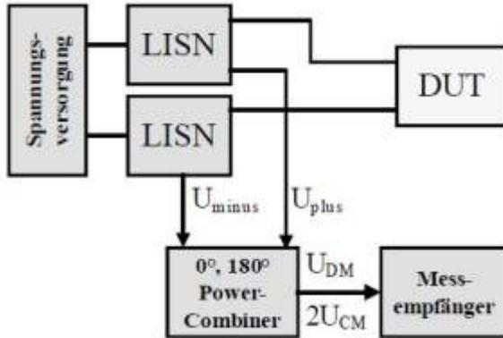
Als Messbeispiel werden die Powersplitter für die Messung des Störspektrums eines klassischen Tiefsetzstellers mit Halbbrücke eingesetzt. Im ersten Schritt werden die Störungen in herkömmlicher Weise mittels nodaler Störspannungen auf den Versorgungsleitungen  $U_{\text{plus}}$  und  $U_{\text{minus}}$  bewertet. Danach erfolgt eine Aufteilung der Störungen in modale Störspannungen, hinsichtlich Gleich- und Gegentaktanteile.
