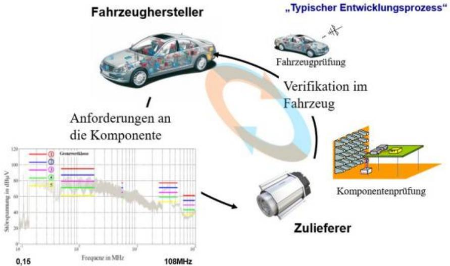
Nachfolgende Abbildung zeigt eine Messung der leitungsgebundener Emissionen mit den Grenzwerten nach CISPR25. Man unterscheidet verschiedene Grenzwertklassen. Der Fahrzeughersteller wählt die Grenzwertklasse für das jeweilige Steuergerät je nach Gefährdungspotenzial und Lage im Fahrzeug. Je näher sich die Komponente an Antennenstrukturen oder Verstärkern befindet, desto strenger muss der Grenzwert gewählt werden.
