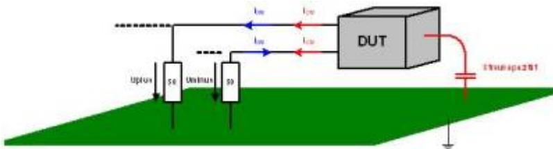
Das Ersatzschaltbild muss somit um den Anteil der Gleichtaktstörungen erweitert werden.
