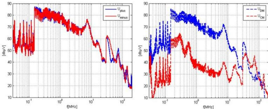
Wie erwartet, ist das Ergebnis der Störspannung an beiden Netznachbildungen für  $U_{\text{plus}}$  und  $U_{\text{minus}}$  nahezu identisch. Eine Aufteilung in Gleich- und Gegentaktanteile zeigt allerdings einen dominierenden Gegentaktanteil der Störungen bis ca. 50 MHz. Danach überwiegt der Gleichtaktanteil, entsprechend der roten Kurve (rechts).
