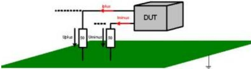
Die Störströme schließen sich differenziell über die Netznachbildungen. Für diesen Fall gilt weiterhin, dass  $I_{plus}$  um  $180^\circ$  phasenverschoben zu  $I_{minus}$  ist. Es existiert somit lediglich eine **Gegentaktstörung**.
