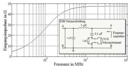
Für Haushalts und Industrielänge geht man von einer deutlich höheren Anschlusslänge aus und damit von einer Induktivität von  $50\mu\text{H}$  pro Leitung, also separat für L und N. Als Ergebnis erhält man zwei Messungen, jeweils gegen der Referenzmasse, in diesem Fall PE. Im Fahrzeug ist die Lage nicht so eindeutig wie an der Steckdose. Unsere Energieversorgung entspricht an der Versorgungsstelle
