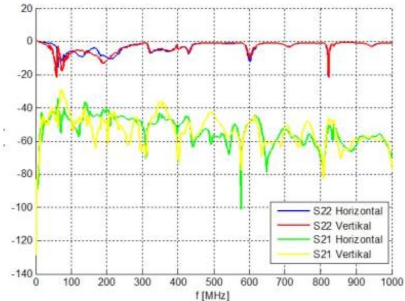
Wir sehen, dass die Polarisation der Antenne teils deutlichen Einfluss auf die Transmission vom Eindraht zu Antenne zeigt (S<sub>21</sub> Transmission Leitung → Antenne). Für jede Polarisation der Antenne ist es nun möglich aus den Messdaten ein äquivalentes Netzwerkmodell zu erstellen und in der Spice-Umgebung anzuwenden.
