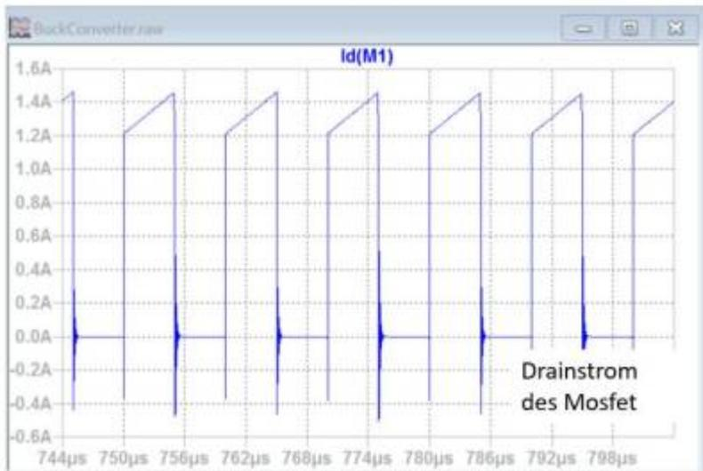
In der Messung sehen wir allerdings nicht direkt die Störungen des Steuersignals, sondern die sich durch den
