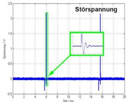
Die PWM- Frequenz wird mit Hilfe der Timer auf ca. 100 Hz eingestellt. Mit dem Lastwiderstand wird die maximale Amplitude definiert. Sie beträgt während der Schaltzeit ca. 2,8 A. Obige Abbildung zeigt den zeitlichen Verlauf des Laststroms sowie die Spannung an der Netznachbildung. Deutlich zu sehen ist die Spannungsüberhöhung die während des Ausschaltvorganges auftritt. Das System aus Induktivität der Netznachbildung und Speicherkapazität wird durch den Schaltvorgang zum Schwingen angeregt.
