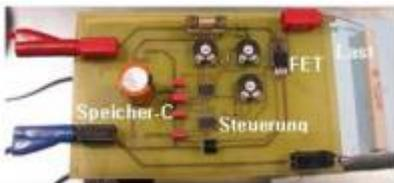
Als Schaltungsbeispiel schauen wir uns die Messergebnisse eines realen, wenn auch sehr einfachen, Tiefsetzstellers an. Der einzige Unterschied zum obigen ESB besteht darin, dass während der Messungen für jeden Leiter eine Netznachbildung verwendet wurde.
