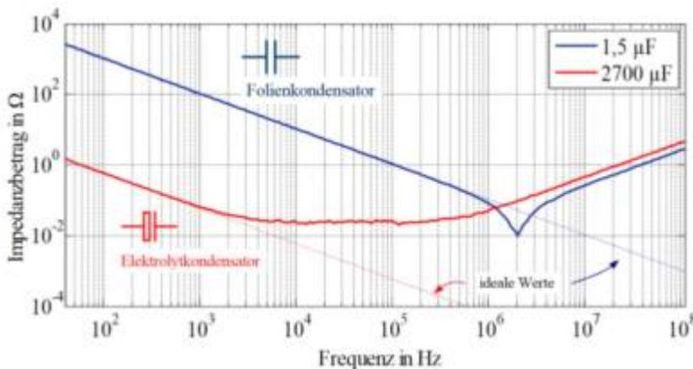
Auch wenn es der Kollege in der Produktion oder Logistik nicht so gerne hört, ist besser Kondensatoren unterschiedlicher Bauform einzusetzen um möglichst für ein breites Frequenzband eine niederimpedante Impedanz darzustellen (wir wollen die hochfrequenten Störgrößen ja gegen Masse kurzschließen).
