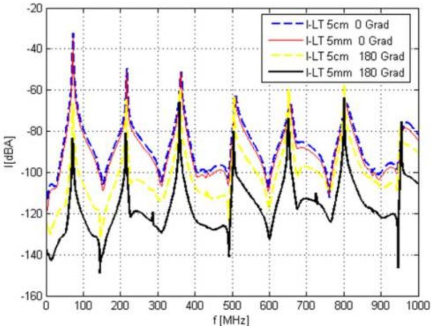
Betrachtet man die Gleichtaktanregung der beiden Leiterkonfigurationen ist zu erkennen, dass sich der reduzierte Leiterabstand nicht auf die Abstrahlung auswirkt (blau vs. rot). Bewertet wird auch hier wieder der Fußpunktstrom des Monopols an 50 Ohm. Die Gegentaktabstrahlung hingegen wird um bis zu 20 dB reduziert (schwarz vs. gelb). Generell ist zu beobachten, dass die Gegentaktabstrahlung unterhalb der Gleichtaktabstrahlung liegt bei identischer Anregung (blau vs. gelb; rot vs. schwarz).
