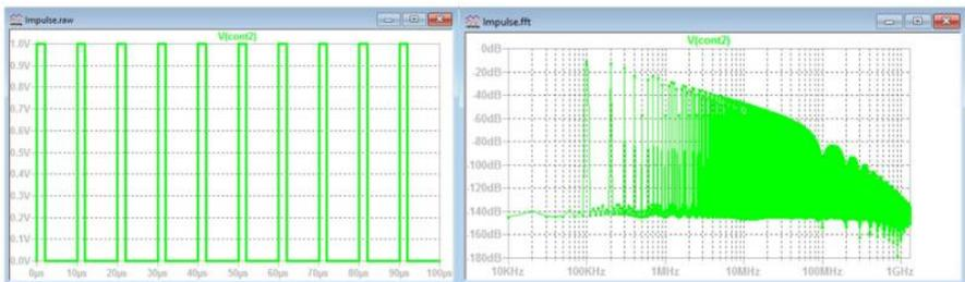
Das Beispiel zeigt ein einfaches Rechtecksignal im Zeitbereich mit der Grundfrequenz von 100kHz (links) mit den dazugehörigen Oberschwingungen im Frequenzbereich. Wir sehen, die Signale sind bis weit in den GHz Bereich erfassbar bzw. verschwinden erst ab ca. 2GHz im mathematischen Rauschen der Berechnung in LT-Spice. Genau diese Signale sind es die uns meist Kopfzerbrechen machen.
