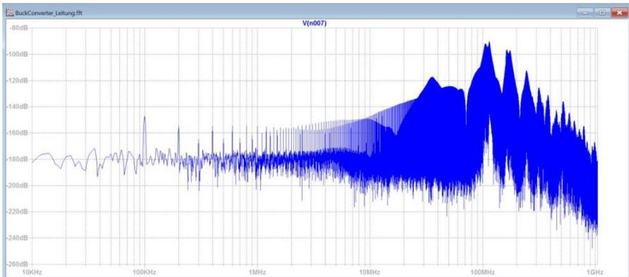
Wir kennen jetzt das Frequenzspektrum der Fußpunktspannung des Monopols, von LT-Spice berechnet in dBV [sprich dBVolt]. Wir suchen jedoch die emittierten Störungen als Feldstärke in dBµV/m [sprich dBmikroVolt pro Meter]. Die Umrechnung zur Messantenne haben wir im vorhergehenden Kapitel besprochen. Das bedeutet wir müssen lediglich zu unserem Ergebnis in dBV die
