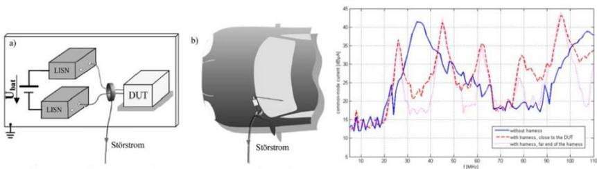
Bereits auf den ersten Blick zeigen sich deutliche Unterschiede zwischen der Messung im klassischen Laboraufbau mit der Netznachbildung und dem Fahrzeugkabelbaum. Die Leitungsresonanzen stechen deutlich hervor und heben jeweils den Störstrom entlang der Leitung deutlich mit bis zu 10dB an. Messbar, aber nur an wenigen Frequenzpunkten wirklich signifikant fällt der Unterschied an verschiedenen Positionen entlang des Kabelbaums aus.
