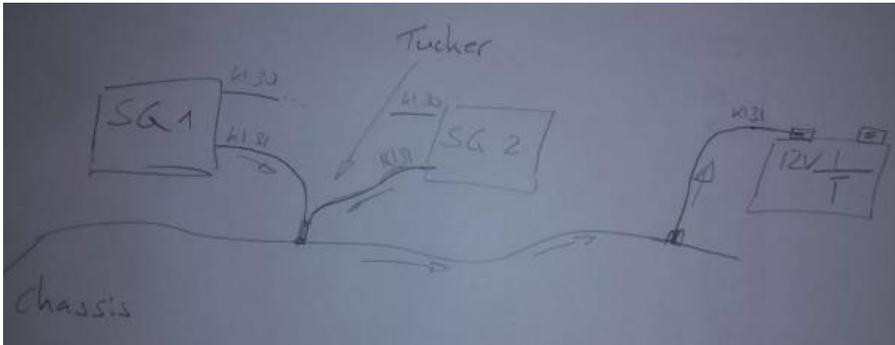
Im Unterschied zum Hausnetz ist es im Fahrzeug, abgesehen von HV-Systemen, nicht notwendig nach Fehlerströmen zu suchen. Der Rückstrompfad erfolgt direkt am Steuergerät über die Kl. 31, wird dann aber lokal auf das Chassis geführt.
