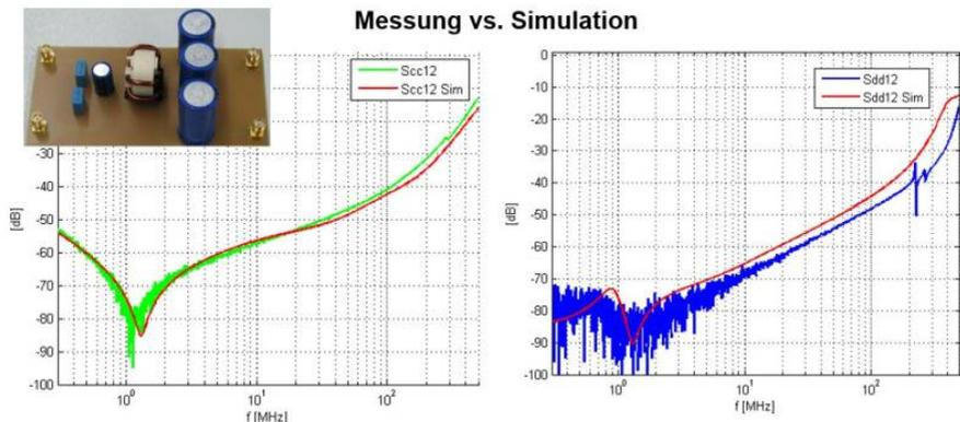
Die Abbildung vergleicht, getrennt nach Gleichtaktdämpfung und Gegentaktdämpfung, jeweils die Messergebnisse (Netzwerkanalysator) mit der LT-Spice Simulation. Die Ergebnisse sind mehr als ausreichend genau und können für weiterführende Simulation herangezogen werden. Im nächsten Schritt würde es sich anbieten die zuvor beschriebene Sensitivität hinsichtlich der Lastimpedanz zu bestimmen.
