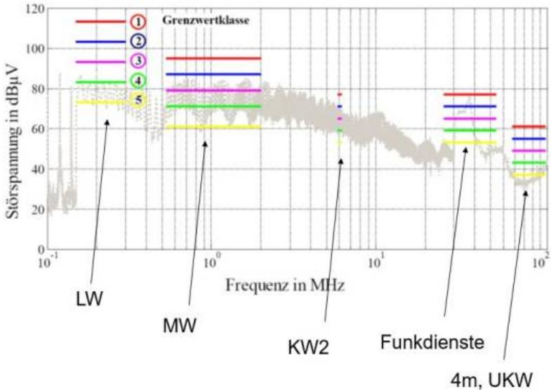
Die Grenzwerte sind nicht für den gesamten Frequenzbereich definiert, lediglich im Bereich der Arbeitsfrequenz der verschiedenen Funksignale. Da in Europa die Lang- Mittel- und Kurzwelle kaum noch nachgefragt werden, kann es sein, dass der Hersteller die Grenzwerte für diesen Bereich ignoriert.
