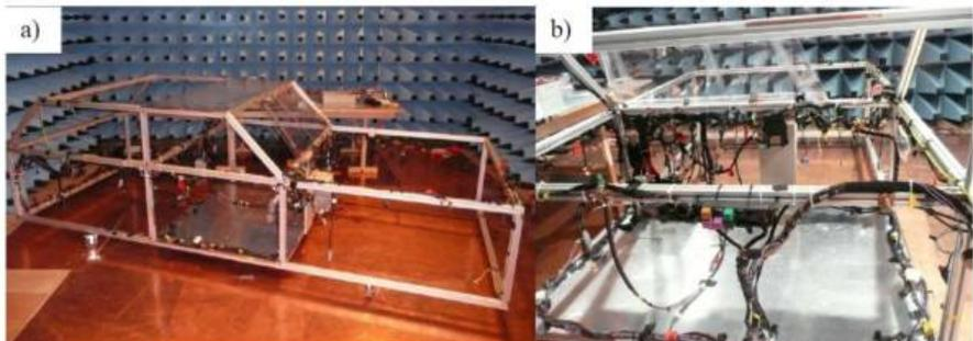
Führen wir jetzt unseren ersten Versuch mit dem Aufbau durch und integrieren den uns sehr gut bekannten Tiefsetzsteller. In unserem Testaufbau bewerten wird dann die ausgehenden Gleichtaktströme. Nachfolgendes Beispiel zeigt den Aufbau in Anlehnung zur Untersuchung eines Scheibenwischermotors mit dazugehörigem Steuergerät.
