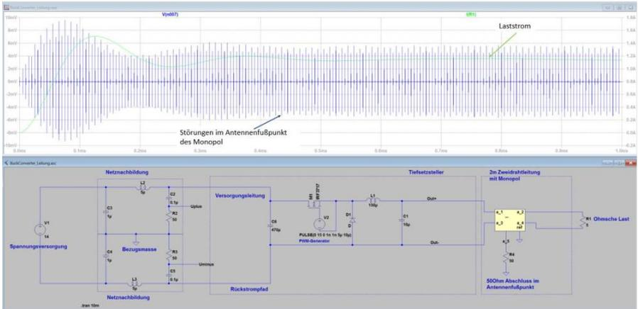
Die Übertragung der Fußpunktspannung am Monopol bringt das gesuchte Ergebnis für die vom Kabelbaum ausgehende Emission. Schön zu sehen sind im Frequenzbereich > 100MHz die Resonanzstellen welche sich aufgrund der Ausbreitung der Störsignale entlang der Leitung ausbilden. Da wir zuvor das gesamte Setup bis 1GHz qualifiziert haben dürfen wir uns auch nur diesen Frequenzbereich ansehen.
