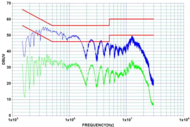
Das Bild zeigt eine Messung der leitungsgebundenen Emission auf den Versorgungsleitungen mit dazugehörigen Grenzwerten.
