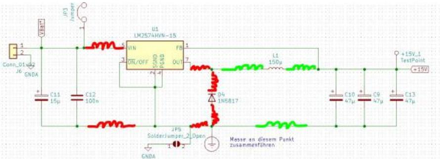
Im gezeigten Schaltplanausschnitt sind in Rot die kritischen parasitären Induktivitäten eingezeichnet, für die kein Freilaufpfad zur Verfügung steht. Die grünen Leitungsinduktivitäten bilden mit der Hauptinduktivität eine Serienschaltung und dürfen zu dieser addiert werden womit sie den Freilaufpfad über die Diode verwenden. Wir können somit in unserer Schaltung „gute und schlechte“ parasitäre Induktivitäten unterscheiden.
