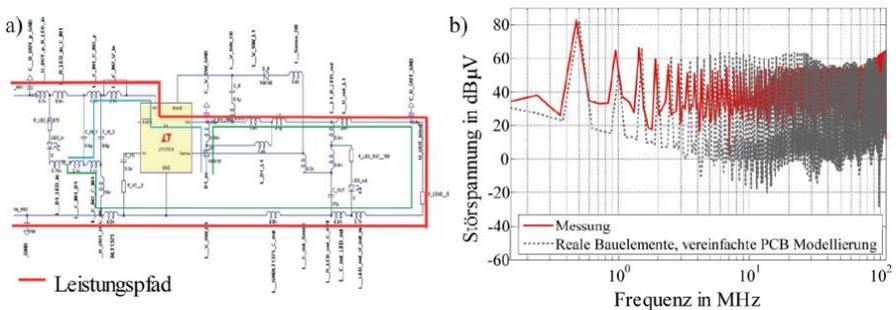
Die Simulationsdauer kann mit dieser Vereinfachung mehr als halbiert werden. Das Ergebnis des reduzierten Modells zeigt nach wie vor eine hohe Übereinstimmung mit den Werten aus der Kontrollmessung. Für eine erfolgreiche Simulation der leitungsgebundenen Störgrößen bis 108 MHz ist es somit ausreichend, den Leistungskreis der Schaltung zu modellieren bzw. die Strompfade mit der höchsten Änderungsgeschwindigkeit ( $di/dt$ ) der Störströme zu berücksichtigen.
