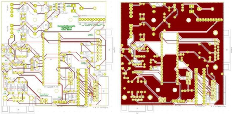
Ich empfehle allerdings stets den Rückleiter zuerst mit Traces auszubilden und sich nicht auf die folgende Massefläche zu verlassen. Um eine möglichst niederohmige Massefläche zu erhalten sollten bei industriell gefertigten Leiterplatten möglichst viele Verbindungen (Vias) zwischen den Masseflächen auf der Ober- und Unterseite hergestellt werden. Es ist nicht schlimm falls die Platine dann wie ein Schweizer Käse aussieht.
