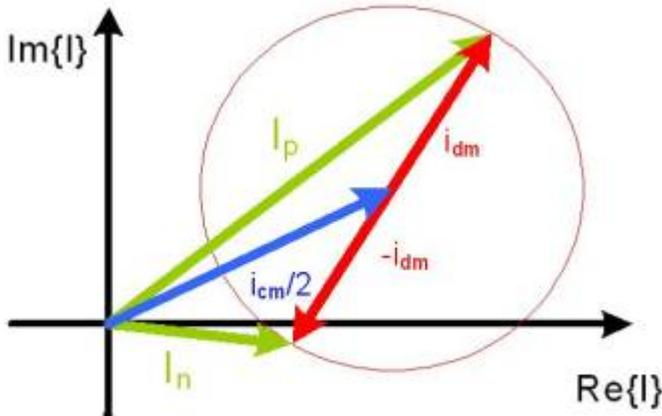
Die Gegentaktstörströme verhalten sich meist wie induktive Ströme. Die Gleichtaktstörströme sind durch die Verknüpfung der Leitungsinduktivität und der Streukapazität geprägt. Die Abbildung zeigt eine beliebig angenommene Phasenlage der modalen Störströme  $i_{cm}$  und  $i_{dm}$  und die daraus möglichen resultierenden nodalen Ströme  $I_p$  und  $I_n$ . Aufgrund der unbekanntenen Phasenlage
