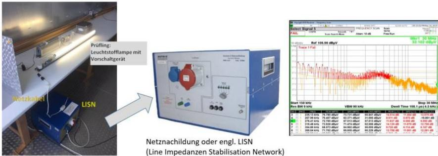
Gemessen wird je nach Anwendung in einem Frequenzbereich von 150kHz bis 110MHz, wobei die exakten Werte je nach Anwendung variieren können (Automotive, Industrie, Rüstung, ...). Als Ergebnis der Messung erhält man typischerweise eine Störspannung in dBµV.
