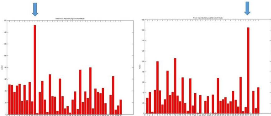
Anzahl an der maximalen Emission über dem Frequenzbereich für einzelne Leiterpaare.
