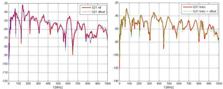
Die Abbildung zeigt die Transmission des Kabelbaums zur bikonischen Antenne (Eingang Kabelbaum → Antenne). Rechts für eine vertikale Polarisation der Antenne, links für horizontale Polarisation. Wir sehen, eine Abweichung von 5 cm zeigt kaum Einfluss auf die Transmission zur bikonischen Antenne. Die Ergebnisse sind nahezu identisch. Es ist somit von einer sehr hohen Reproduzierbarkeit auszugehen, selbst bei einer leicht fehlerhaften Positionierung der Empfangsantenne.
