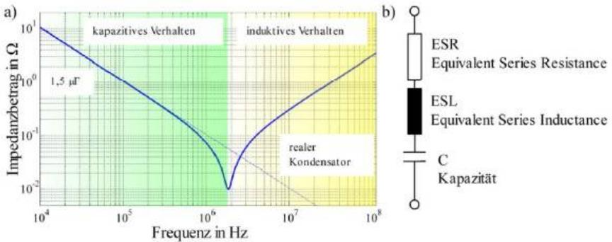
a) Impedanzverlauf eines 1,5  $\mu\text{F}$  Folienkondensators, b) HF-Ersatzschaltbild.
