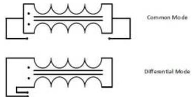
Das Datenblatt zeigt zwei Messkurven getrennt nach Gleich(comm)- und Gegentaktimpedanz(diff). Gemessen wird der Impedanzverlauf typischerweise mit einem Impedanzanalysator mit Hilfe zweier Messschaltungen, dargestellt im Bild rechts.
