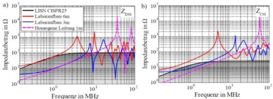
Die schwarze Kennlinie zeigt die standardisierte Eingangsimpedanz bei der Verwendung von zwei Netznachbildungen. Im differentiellen Pfad ergibt sich eine Serienschaltung mit  $100\Omega$ , für die Gleichtaktimpedanz eine Parallelschaltung und damit  $25\Omega$ . Schön zu sehen sind die aufgrund der Leitungsresonanzen entstehenden Minima und Maxima der Impedanzen in Abhängigkeit der Leitungslänge. Bei allen Messungen zeigt sich folgender Effekt:
