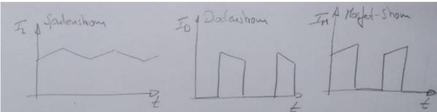
Diese kommutierenden Ströme bringen gleich mehrere Probleme mit sich. Einerseits generiert dieser Stromverlauf weit höhere Emissionen als der rein dreieckförmige Verlauf (rein aus der Fourier-Reihe betrachtet), zum anderen erhalten wir aufgrund der springenden Ströme Spannungsüberhöhungen an parasitären Kapazitäten.
