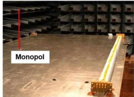
Aus rein statischen Verhältnissen wurde der Monopol mit einer Gesamtlänge von 0,66 m und einem Radius von 1,1 mm gewählt. Über die N-Buchse kann der Monopol von unten kontaktiert werden. Die Eingangsreflexion des Monopols zeigt die charakteristischen Resonanzstellen, entsprechend der Leiterlänge, mit  $\lambda/4$ ,  $3\lambda/4$ ,  $5\lambda/4$  und  $7\lambda/4$ .
