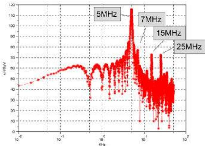
Aus dem breitbandigen Grundpegel des Störsignals ragen die schmalbandigen Anteile bei 5, 7, 15 und 25MHz heraus. Doch welche Frequenzanteile werden in den einzelnen Zeitabschnitten generiert? Mit der Short- Time FFT kann nun der Zusammenhang zwischen Zeit- und Frequenzbereich hergestellt werden.
