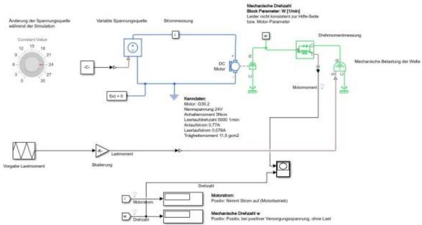
Machen Sie sich bitte nun mit geeigneten Anzeigeelementen mit dem Aufbau vertraut und spielen Sie einige Fälle durch. Es geht jetzt primär darum die Vorzeichen zu verstehen. Notieren Sie sich dazu jeweils stichwortartig die Zusammenhänge. (z.B. Positiver Motorstrom → positive Drehzahl falls Lastmoment < Anzugsmoment)
