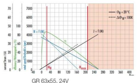
Das vollständige Datenblatt und die Kenndaten der Maschine finden sie auf der Homepage der Firma Dunkermotoren. Einen Teil der Kennlinien werden wir mit Hilfe des Versuchsstands im Folgenden selber ausmessen.
