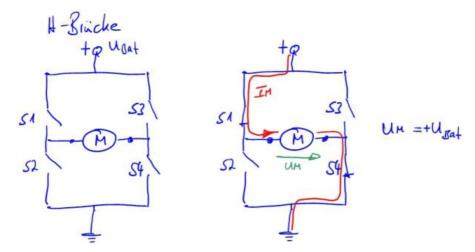
Im Bild dargestellt ist die H-Brückenschaltung mit den vier notwendigen Schaltern und dem Motor in der Mitte der Brücke. Werden die Schalter S1 und S4 geschlossen, verbinden wir den linken Motoranschluss mit + UBat, den rechten Anschluss mit GND. Damit liegt die volle Versorgungsspannung über dem Motoran. Nehmen wir einfach an. das wäre dann der Rechtslauf.
