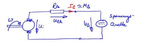
Schauen wir uns dazu das bekannte Ersatzschaltbild der Gleichstrommaschine an, allerdings jetzt für den Generatorbetrieb. Die Stromrichtung kehrt sich um und bei gleicher Polarität der Spannung damit auch der Leistungsfluss. Welcher Strom sich einstellt und damit das Belastungsmoment an der Welle (auch hier gilt natürlich M~I) hängt von der Spannungsdifferenz zwischen induzierter und angelegter Spannung ab sowie vom Ankerwiderstand.
