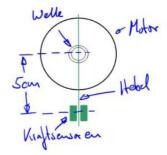
Tritt eine Belastung der Maschine auf stützt sie sich über den Hebelarm auf den Kraftsensoren ab, eine sogenannte Drehmomentstütze. Bei bekannter Länge des Hebelarms lässt sich aus der erfassten Kraft F das am Motorgehäuse angreifende Drehmoment ermitteln welches dem Moment an der Welle entspricht.
