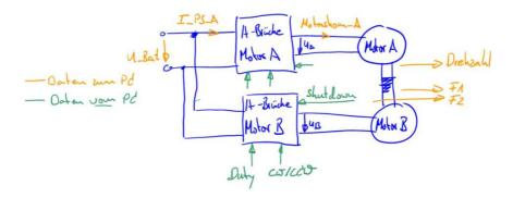
In oranger Farbe dargestellt sind die Daten welche vom Mikrocontroller an Simulink übertragen werden. Steuerbefehle von Simulink zum Prüfstand sind in Grün dargestellt. Die Daten werden alle 100ms aktualisiert.
