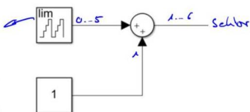
Über die Sample-Time lässt sich einstellen wie lange der Rotor in einem Sektor verbleibt. Aber welcher Zusammenhang besteht zur am Motor angelegten Spannung? Um dies herauszufinden gibt es die Möglichkeit den Duty-Cycle der Mosfets zu variieren. Dadurch wird ein PWM-Muster ausgegeben und die am Motor anliegende Spannung berechnet sich zu Duty x Eingangsspannung.
