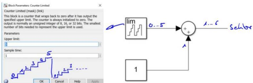
Die Sample-Time entscheidet darüber wie schnell sich der Motor dreht. Aber welcher Zusammenhang besteht zur am Motor angelegten Spannung? Um dies herauszufinden gibt es die Möglichkeit den Duty-Cycle der Mosfets zu variieren. Dadurch wird ein PWM-Muster ausgegeben und die am Motor anliegende Spannung berechnet sich zu Duty x Eingangsspannung.
