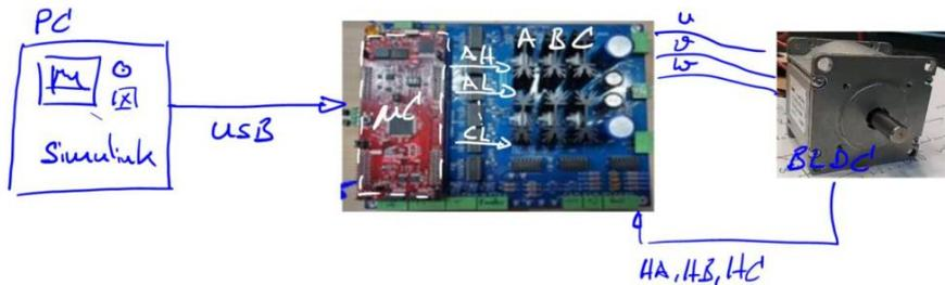
Die Programmierung unserer Schalterstellungen erfolgt sehr komfortabel in Matlab-Simulink. Zur Einstellung der richtigen Schalterstellungen befüllen wir eine Switch-Case Anweisung mit dem notwendigen binären Muster, passend zum aktuellen Sektor. Achten Sie auf die korrekte Schreibweise des Patternvektors in der Form [AH AL BH BL CH CL] wie im Beispiel für unseren bereits bekannten Sektor 6 dargestellt.
