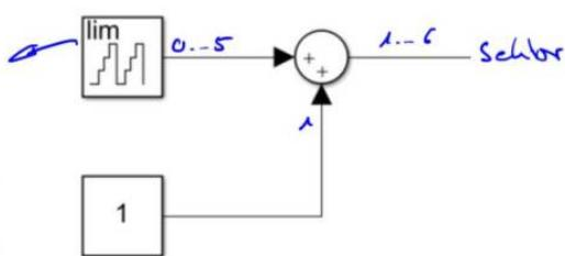
Über die Sample-Time lässt sich einstellen wie lange der Rotor in einem Sektor verbleibt. Aber welcher Zusammenhang besteht zur am Motor angelegten Spannung? Um dies herauszufinden gibt es die Möglichkeit den Duty-Cycle der Mosfets zu variieren. Dadurch wird ein PWM-Muster ausgegeben und die am Motor anliegende Spannung berechnet sich zu Duty x Eingangsspannung. (Hinweis: Zum Schutz des Motors wird der maximal einstellbare Duty-Cycle durch Simulink auf 15% begrenzt.)
