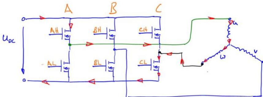
Pro Brückenzweig darf natürlich immer nur ein Schalter, entweder AH oder AL geschlossen sein. Andernfalls würden wir einen harten Kurzschluss der Eingangsspannung erhalten. In der Leistungselektronik spricht man in diesem Fall von einem „heißen Zweig“. Wir können jetzt unsere Sektortabelle um die Schaltzustände erweitern:
