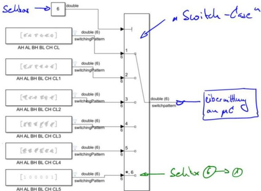
In der Simulink-Vorlage finden Sie neben dem Kommunikationsblock auch die Vorlage der Switch-Case Anweisung.
