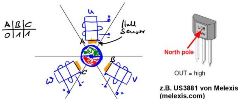
Jeder Sektor besitzt somit seine eindeutige Hall-Signatur. Im gezeigten Beispiel besitzt Sektor 1 den Hall-Code 011 in der Reihenfolge A-B-C Sensor. Es ist allerdings nicht selbstverständlich, dass die Sensoren in dieser Reihenfolge herausgeführt sind. Weiterhin können natürlich auch Sensoren eingesetzt werden welche einen aktiven Low-Pegel verwenden.
