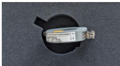
Mit unserer neuen Stromzange F52B können wir nun auch Gleichtaktströmen auf Versorgungs- und Signalleitungen auf den Grund gehen. Gleichtaktströme werden auch als Antennenströme bezeichnet, da sie für einen Großteil der emittierten elektromagnetischen Störungen verantwortlich sind.
