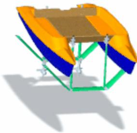
Den ganzen Sommer über haben unsere Kollegen aus der Fakultät Maschinenbau konstruiert und Berechnungen durchgeführt zum Aufbau der neuen Tragflügelstruktur die aus unserem Katamaran endlich ein echtes Tragflügelboot
