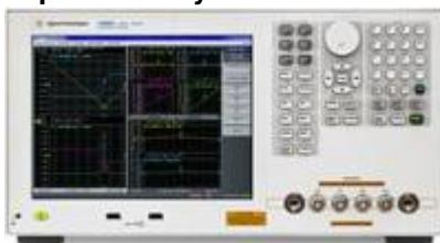
Das Labor für Leistungselektronik bzw. elektromagnetische Verträglichkeit (EMV) hat jüngst ein neues Messgerät erhalten, mit welchem sich das frequenzabhängige Verhalten passiver Bauelemente exakt bestimmen lässt.
