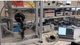
Zukünftig können Studierende der Vorlesung elektrische Antriebe das Verhalten verschiedener elektrischer Antriebe selber ausprobieren und testen. Ein Baustein der Versuche ist unser neuer BLDC Fahrradprüfstand an dem sich die Eigenschaften und Funktionsweise moderner BLDC
