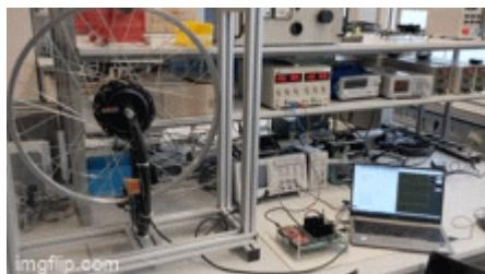
Zukünftig können Studierende der Vorlesung elektrische Antriebe das Verhalten verschiedener elektrischer Antriebe selber ausprobieren und testen. Ein Baustein der Versuche ist unser neuer BLDC Fahrradprüfstand an dem sich die
