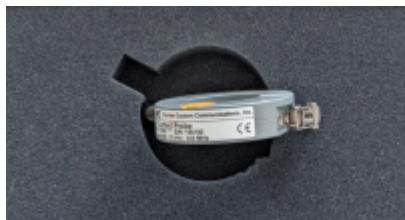
Mit unserer neuen Stromzange F52B können wir nun auch Gleichtaktströme auf Versorgungs- und Signalleitungen auf den Grund gehen. Gleichtaktströme werden auch als Antennenströme bezeichnet, da sie für einen Großteil der emittierten elektromagnetischen Störungen verantwortlich sind.
