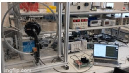
Zukünftig können Studierende der Vorlesung elektrische Antriebe das Verhalten verschiedener elektrischer Antriebe selber ausprobieren und testen. Ein Baustein der Versuche ist unser neuer BLDC Fahrradprüfstand an dem sich die Eigenschaften und Funktionsweise moderner BLDC Motoren testen lassen.
