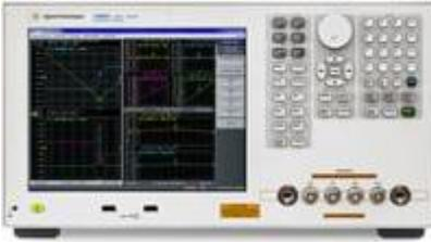
Das Labor für Leistungselektronik bzw. elektromagnetische Verträglichkeit (EMV) hat jüngst ein neues Messgerät erhalten, mit welchem sich das frequenzabhängige Verhalten passiver Bauelemente exakt bestimmen lässt.
