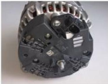
Der Drehstromgenerator in modernen Fahrzeugen ist schon lange keine permanenterregte Gleichstrommaschine mehr, wie noch weithin angenommen. Besonders Fahrzeuge im Premiumsegment haben einen Leistungsverbrauch im Bereich von 3-4kW auf der 12V- Seite mit steigender Tendenz. Für die Versorgung des 12V Bordnetz kommen heute Drehstromgeneratoren zum Einsatz.
