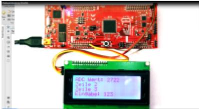
Konstantin Lutz hat in seiner Bachelorarbeit eine Displayansteuerung implementiert für unsere universelle Hardwareplattform in der Leistungselektronik. Das Display kann nun für weitere Projekte komfortabel in die Simulink-Umgebung eingebunden werden. Ohne sich um die Details kümmern zu müssen können die einzelnen Zeilen ganz
