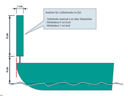
Bild 3: Schematische Darstellung der Auslösevorrichtung
