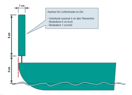
Bild 3: Schematische Darstellung der Auslösevorrichtung
