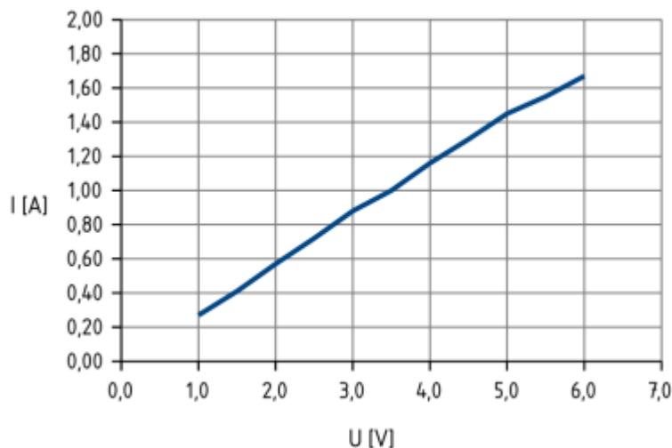
Für die Stromaufnahme eines **einzelnen** Motors mit Luftschaube ergibt sich folgende Kennlinie:
