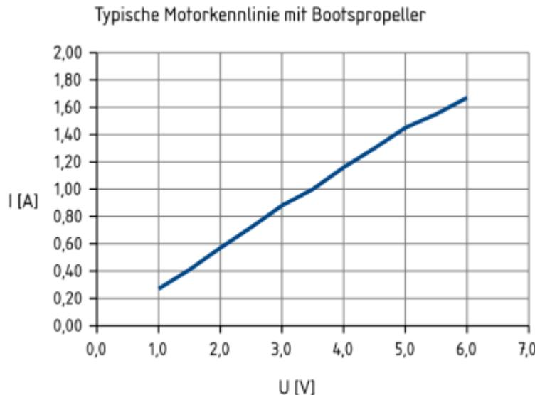
Für die Stromaufnahme eines **einzelnen** Motors mit Luftschaube ergibt sich folgende Kennlinie:
