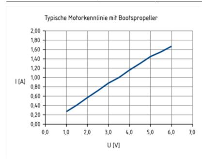
Für die Stromaufnahme eines **einzelnen** Motors mit Luftschraube ergibt sich folgende Kennlinie:
